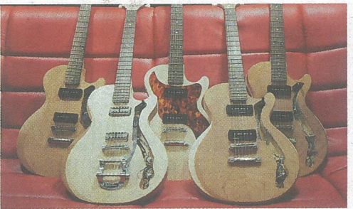
能登の古材と能登ヒバを活用したエレキギター。輪島市の西慶寺の古材をコントロールルームに使い、床には能登ヒバのフローリングを張っている。さらに、後藤氏のエレキギターでは、ボディには住宅の縁側で使われていたケヤキを使用、ネックには能登ヒバの圧縮材を使っている。
